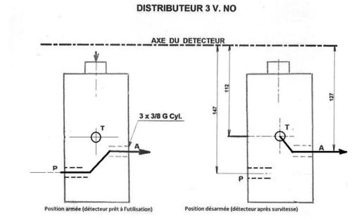
NOTA : Nous attirons votre attention sur le fait qu'une fois le bloc hydraulique HYC3 NO monté sur notre détecteur de survitesse, celui-ci fonctionnera à l'inverse du schéma hydraulique indiqué sur la plaque signalétique du bloc HYC3 NO. En effet, quand le détecteur est en position armé (pas de survitesse détectée), le fluide est passant entre P et A et quand le détecteur est en position désarmé (survitesse détectée), le fluide est passant entre T et A (voir schéma ci-dessus).
